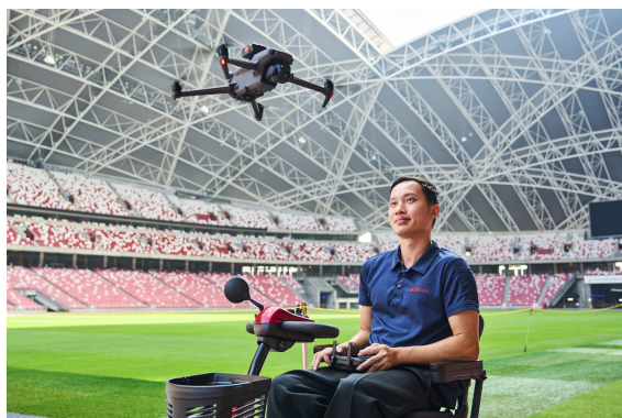
Système d'inspection des infrastructures par drones au Singapore Sports Hub
